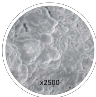
Esta muestra de hormigón no densificado revela la estructura porosa que produce desgaste y deterioro.
